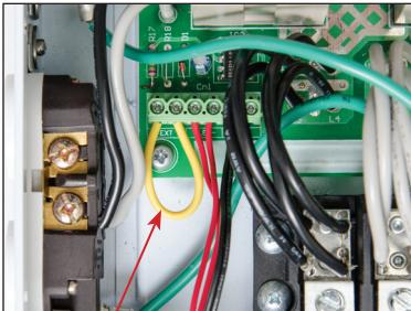
LOW VOLTAGE TRIGGER CONNECTION
