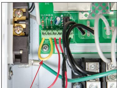
CABLE ADAPTADOR PARA BAJO VOLTAJE
