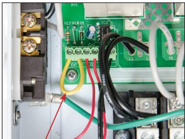
LOW VOLTAGE TRIGGER CONNECTION
